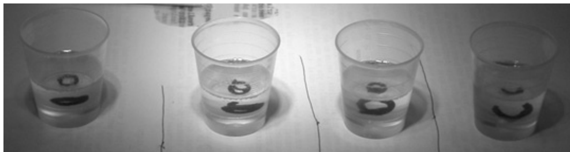
Fig c. Ringarna placerade i formarna och gjutmassan påfylld innan härdning.
